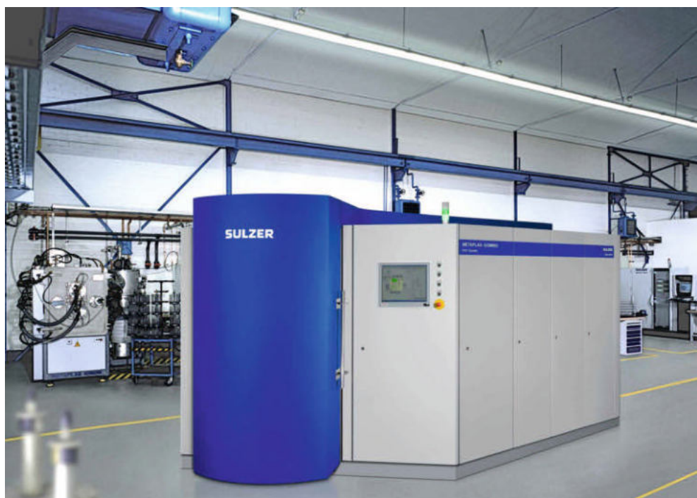
1 Das Arc-Verfahren wird weiterhin die dominierende Technik in der Hochleistungsbeschichtung für Werkzeuge sein. Eine Voraussetzung ist die permanente Weiterentwicklung der Beschichtungsanlagen. Im Bild: das modulare Konzept Metaplas-Domino
