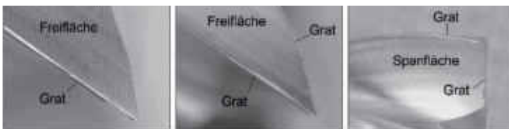
Bild 4. Fertigungsbedingte Gratabbildung bei den HSS-Fräsern im Anlieferungszustand
