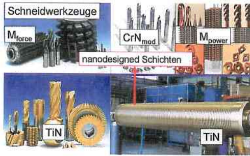
Abb. 8: Auswahl von spanenden Werkzeugen mit klassischen Schichten und Nanoschichten
