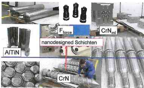
Abb. 9: Auswahl von Umformwerkzeugen und Plastifizierschnecken mit klassischen Schichten und Nanoschichten
